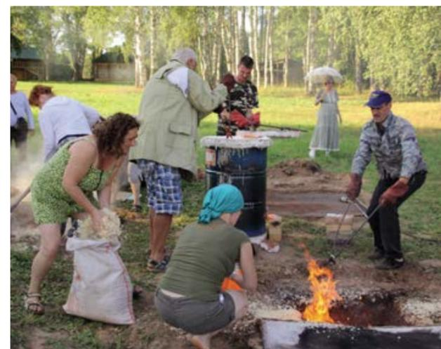
ют в ямку, вырытую в земле, на дно которой насыпаны опилки. Сверху заготовку сразу засыпают опилками, и ямку закрывают металлическим листом. Опилки вспыхивают, огонь в ямке сжигает кислород, происходит восстановление глазури, содержащих металлы, — в результате керамическое произведение приобретает непредсказуемо красивые эффекты, а сам процесс завораживает какой-то мистической сказочностью. Кроме «Раку» в Рябово были газовые обжиги (утильные и политые) и дровяные.
