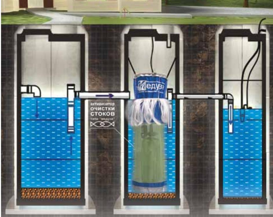
Работа АОС «Медуза» основана на использовании гидроэжекционного принципа насыщения воды кислородом воздуха. Опуская в емкость (достаточных размеров) АОС «Медуза», мы получаем аэротенк, совмещенный с биофильтром (корпус АОС «Медуза»).
